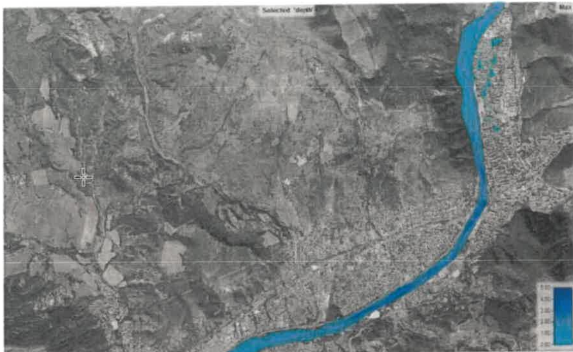
Figure 26: Hauteurs d'eau maximales (m) dans le scénario 8B avec une crue décennale sur la Bléone
