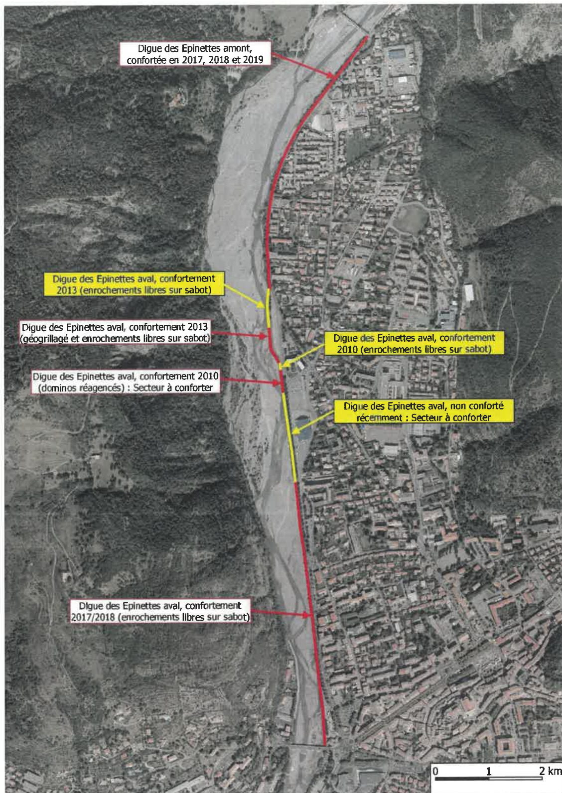
Localisation des digues Epinettes amont et aval, avec les différents secteurs confortés ou non
